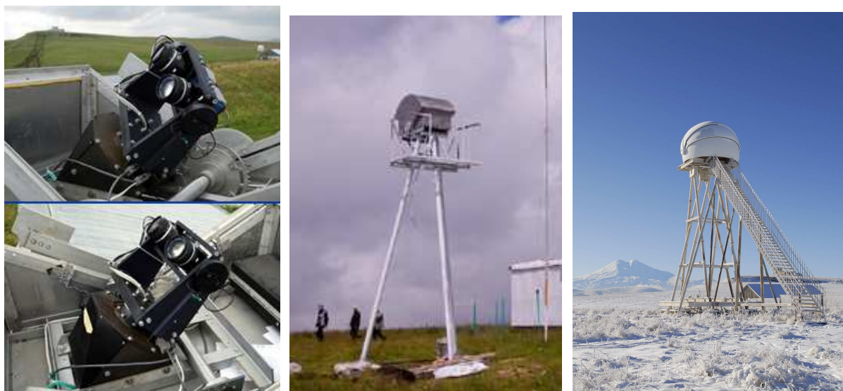
Рис. 1: Оборудование системы МАСТЕР установленное в горах на Кавказской Горной Астрономической Обсерватории МГУ под Кисловодском. Слева направо:1) восточная и западная камеры северной установки МАСТЕР-VWF4,2) опорная башня и укрытие разработанные В.Корниловым и Н.Шацким южной установки МАСТЕР-VWF4 (оба табл. 2 : 5);3) опорная башня шипокопального телескопа МАСТЕР-2 табл. 2 : 4
